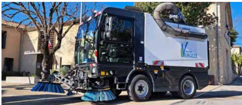
La machine est équipée de brosses de nettoyage, d'une manche d'aspiration très puissante, d'une rampe de jets haute pression idéale lors des nettoyages de voiries après les fêtes ou sinistres météo, elle est également pourvue d'une lance haute pression très pratique et polyvalente.
